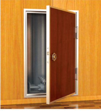
Römorkörlerde zincir bırakma mahalli kapağı
