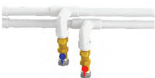
Temiz su boruları, PVC'dir.
