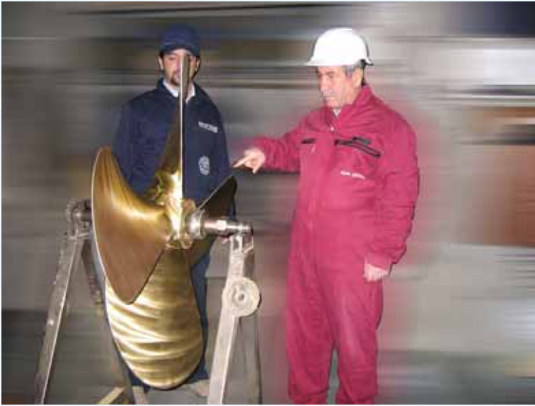
Türk Loydu tarafından pervanenin balansının kontrol edilmesi. Static balancing of the propeller by Turkish Loyd
