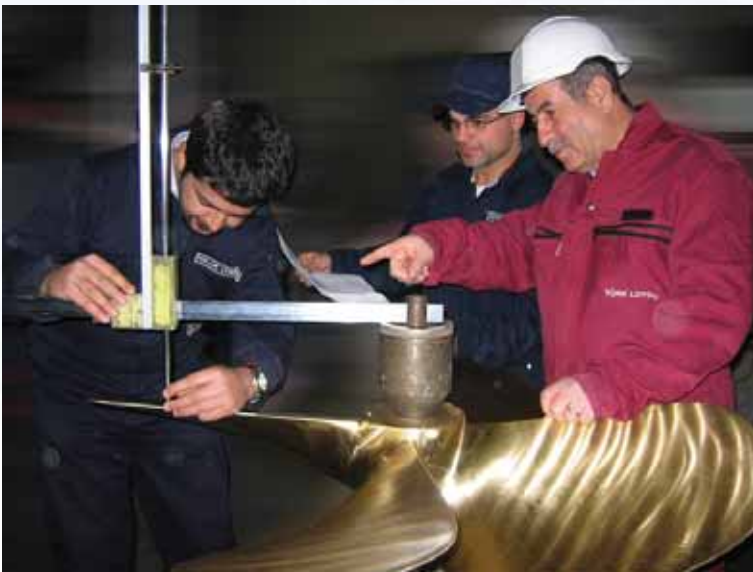
Türk Loydu tarafından pervane ölçülerinin kontrolü. Last controls by Turkish Loyd
