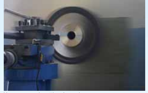
Yatay tornada göbeğin açılması
