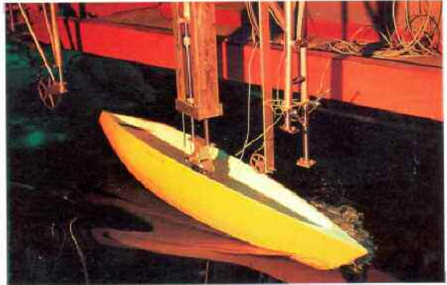
Yelkenli tekne modeli 5° meyil 12° sürüklenme açısında çekilirken
