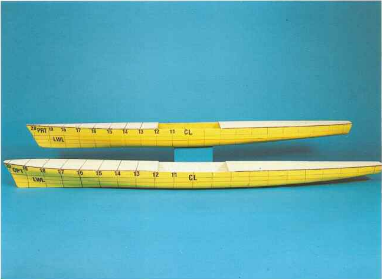
Başlangıç Dizaynı (PRT) ve Optimum Dizayna (OPT) Ait Modeller
