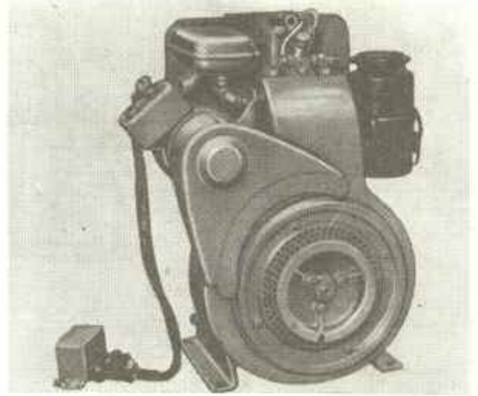
Şek. 44 Dinamotorlu elektrik tertibatı
