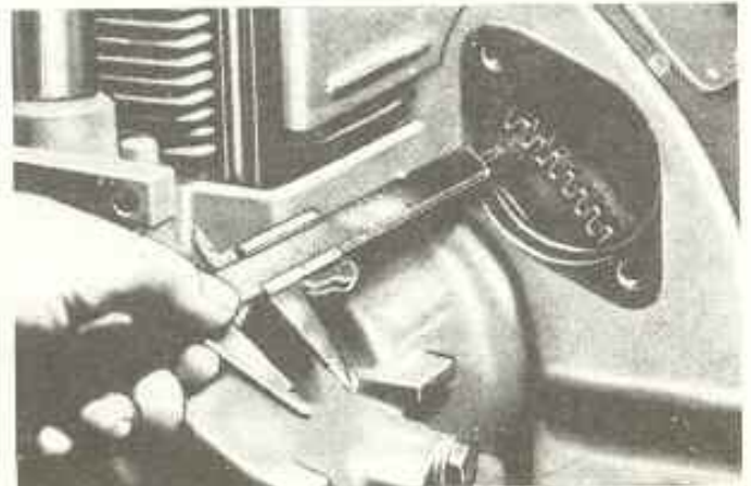
Şek. 73 Marş dişlisi uzaklığı ölçülmesi
