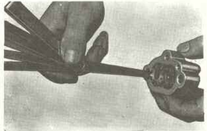
Şekil 24 Yağ pompası kontrolü
