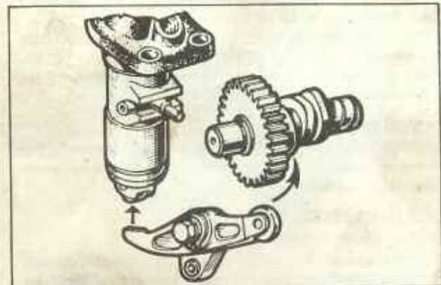
Şek. 25 Külbütör kolu ile enjektör pompasının çalışması
