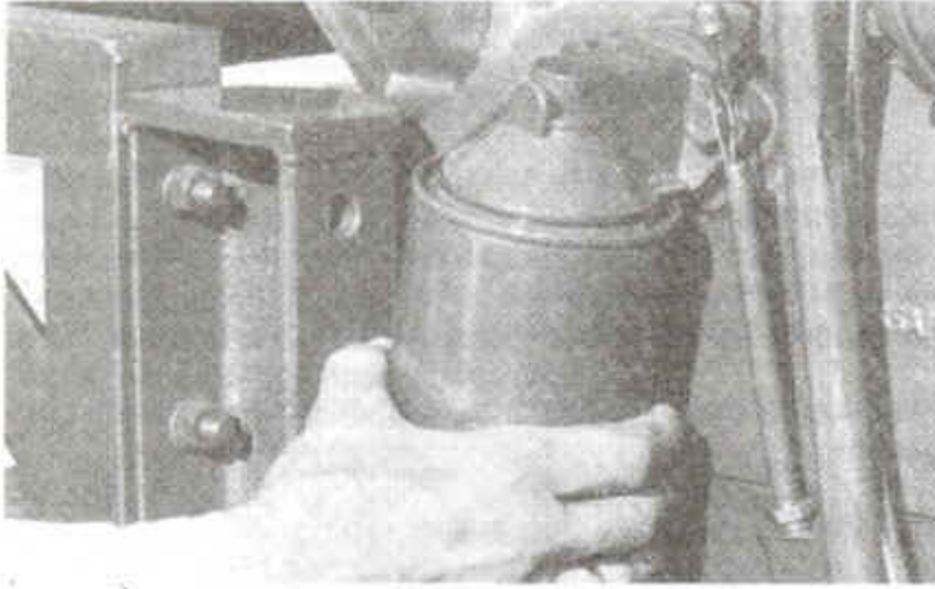
Şek. 29— Yağ Filtre Elemanının Değiştirilmesi
