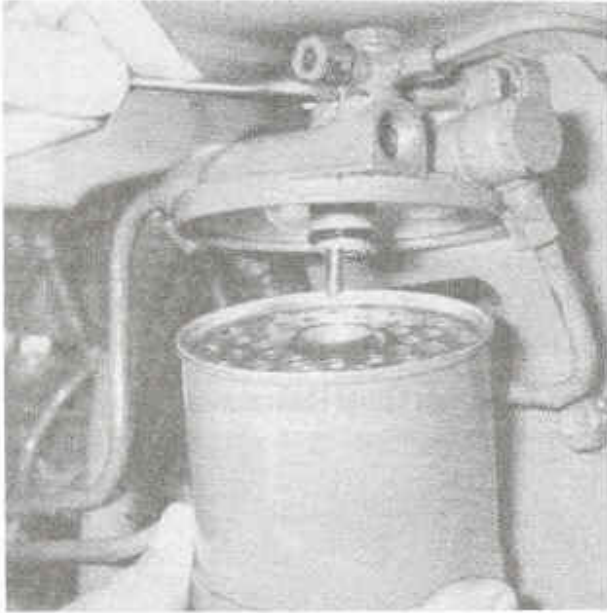
Şek. 32— Yakıt Filtre Elemanının Yenilenmesi
